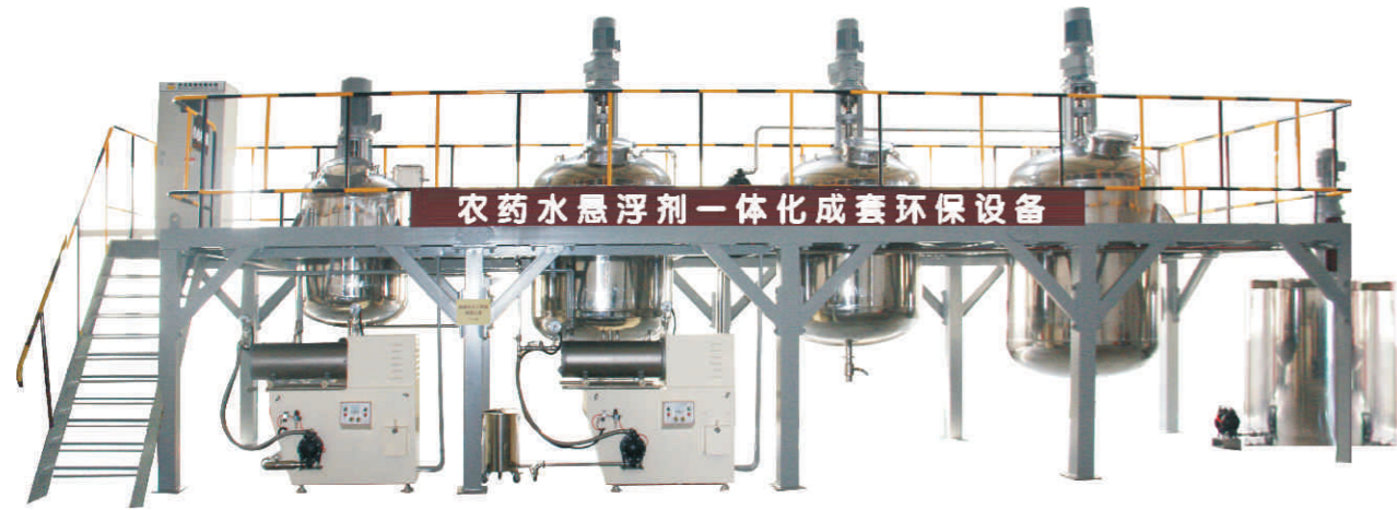
公司产品在台湾日产化工的水悬浮剂成套生产线
