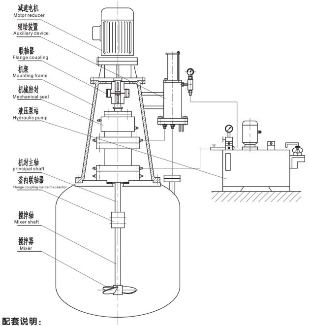
搅拌传动密封装置整套设计、制造可以实现含搅拌器、搅拌轴、凸缘法兰、上轴、机架、机械密 封、电机、减速机在内的所有配件套体组合、测试、运输。避免出现各配套厂家互相推诿、扯皮现 象,提高整体质量,减少配套之间的配合带来的精度问题。
